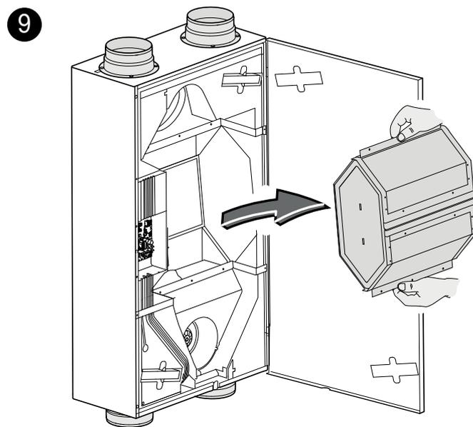
DE 10 Nach Demontage des vorhandenen Tauschers den Enthalpie-Wärmtauscher einsetzen.
