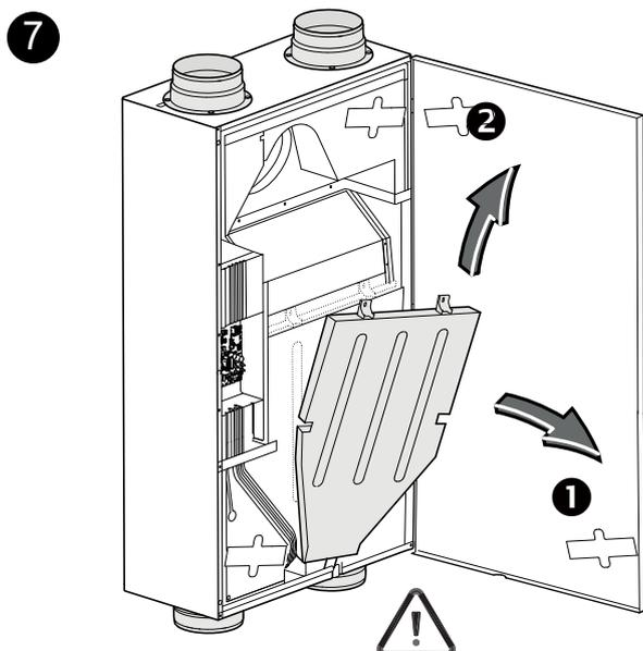
DE Bei Deckenmontage den Kondensatbehälter vorsichtig lösen. Es kann sich nämlich noch eine geringe Kondens-wassermenge im Kondensatbehälter befinden!
